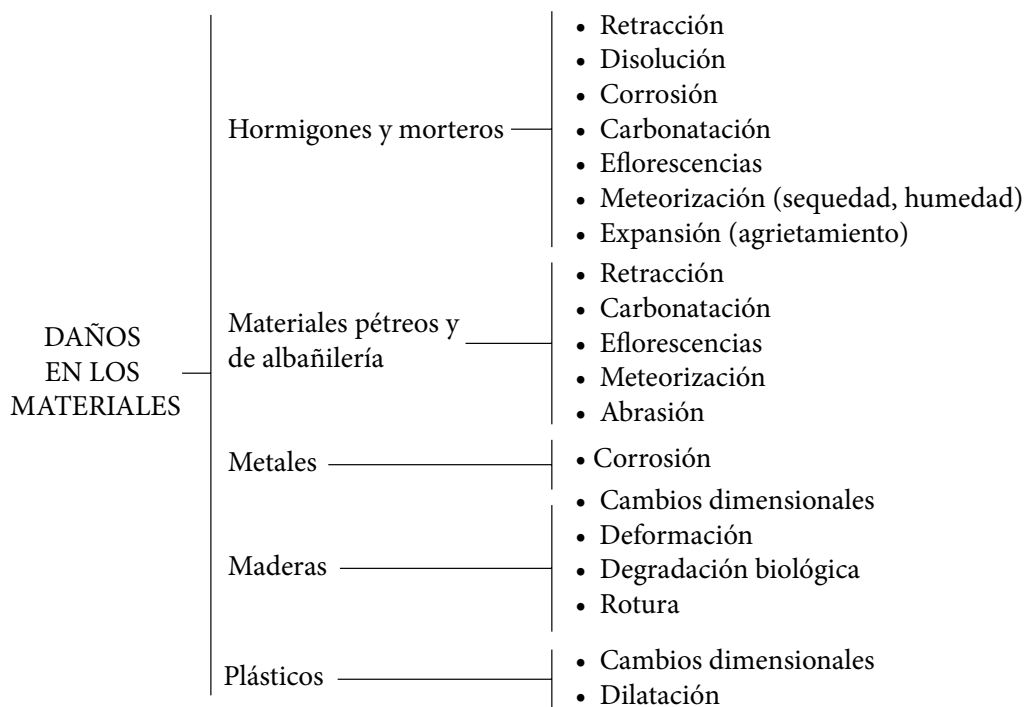
Figura 3.2. Daños en los materiales
