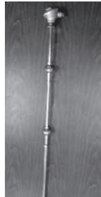
Figura 3.11 Reeds switches para medida de nivel
