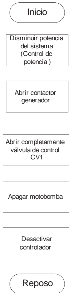
Figura 3.6 Secuencia de control para parada del SGEH
