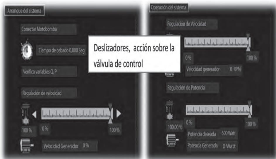
**Figura 4.39** Regulación de velocidad y potencia modo semiautomático-Panel secuencia SGEH
