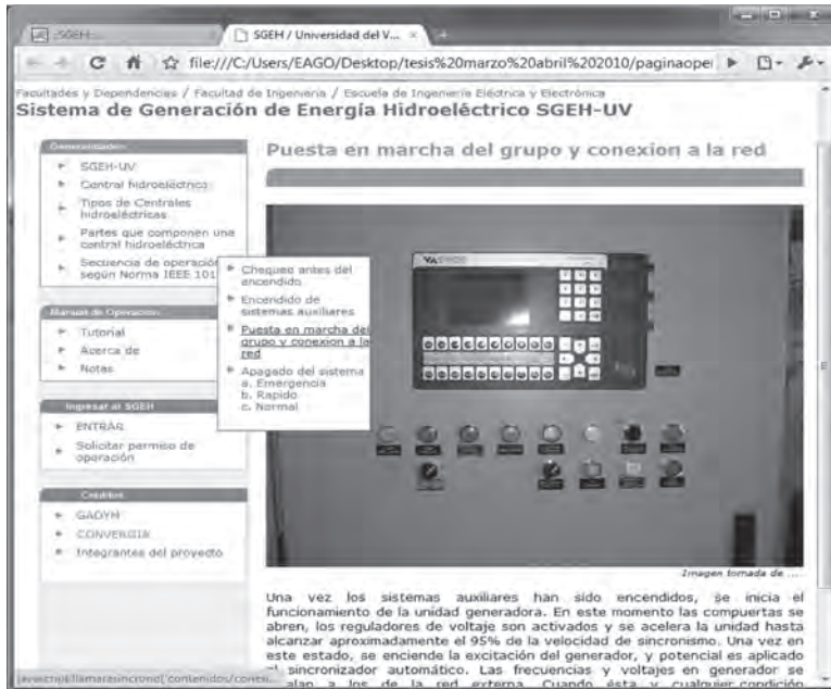
Figura 7.21 Página de secuencia de operación según la norma IEEE 1010, puesta en marcha del grupo
