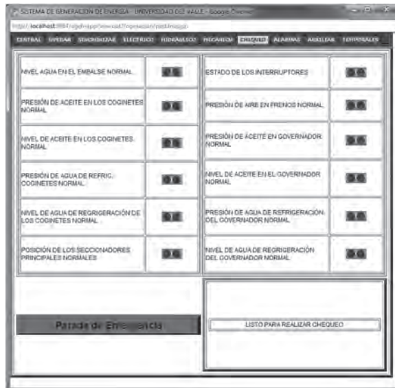
Figura 7.32 GUI de operador con la ventana “CHEQUEO” activada
