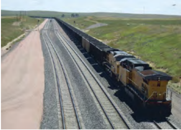
Tren que conecta El Cerrejón con Puerto Bolívar. Hay 18 locomotoras. Cada una tira de 150 vagones. Cada vagón carga 110 toneladas de carbón. Imagen tomada de https://bit.ly/3oSGG1f
