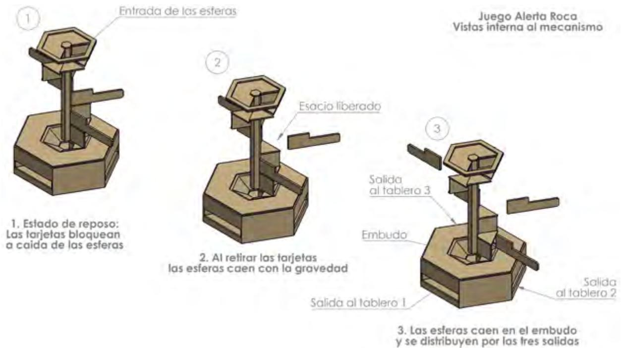
**Figura 103.** Unidad interactiva "Alerta roca": Diseño y mecanismo interior del tablero tridimensional.
