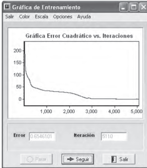
Fig. 3.30 Curva del error cuando \alpha = 0.005 \beta = 0.1
