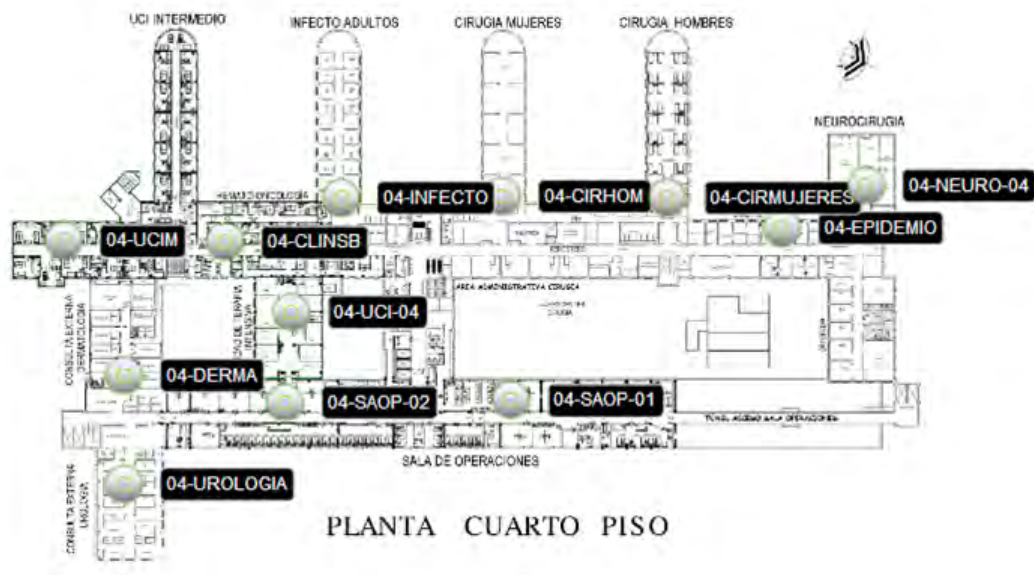
Figura 26. Plano del cuarto piso con ubicación de los Acces Points instalados.
