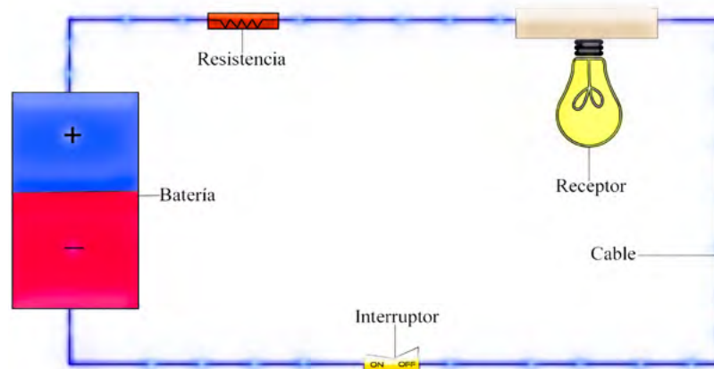
Figura 1. Partes de un circuito eléctrico
