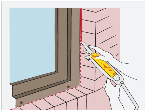
Figura 4.6 Sellado del perímetro de las ventanas
