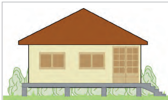
Figura 4.27 Edificación sobre losa elevada del terreno
