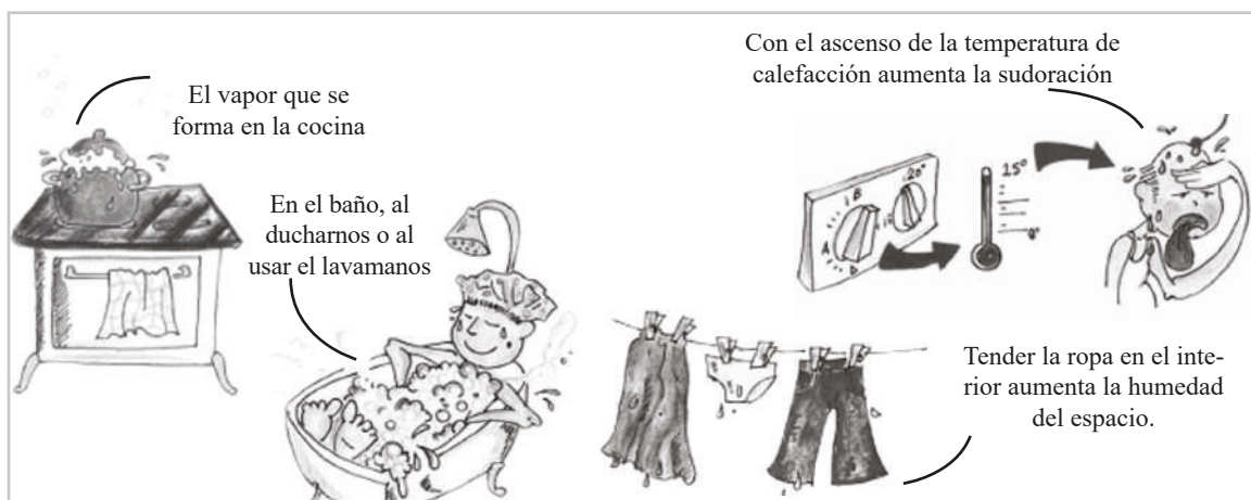
Figura 2.8 Generación de humedad dentro de la casa
