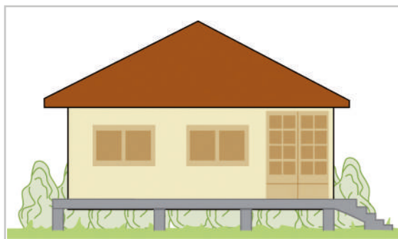
Figura 4.27 Edificación sobre losa elevada del terreno
